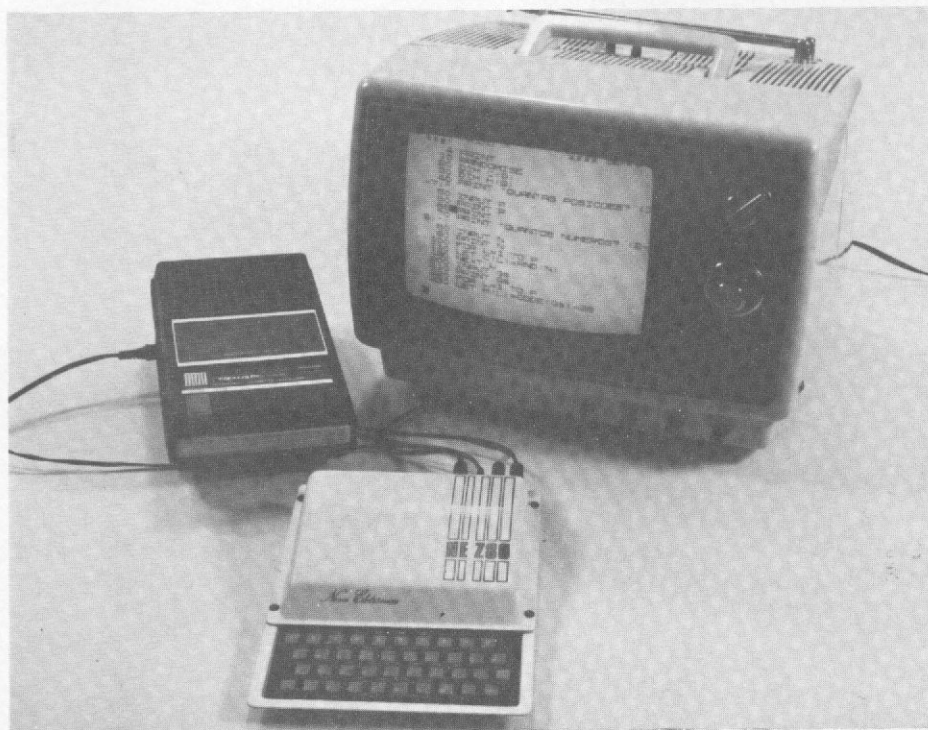
Com microprocessador Z 80 e 1 K de memória, o NE-Z80 tenta atingir os iniciantes.
